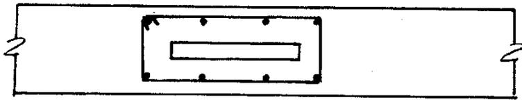
附图 5.3 钢箍的钢筋骨架
